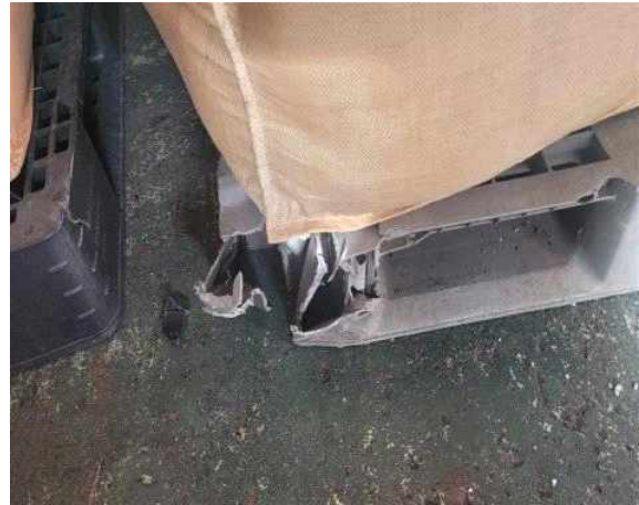
[팔레트 모서리 부분의 파손상태]
