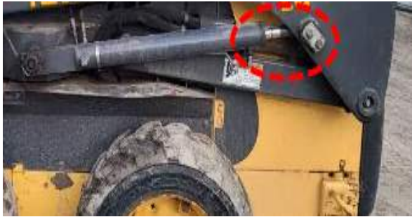
[사진4] (좌측) 올바르게 고정된 로더 암 실린더의 예시 (참고용)
