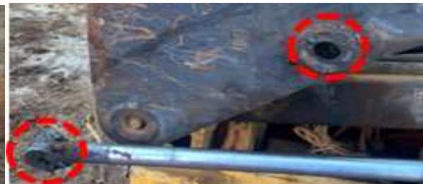
[사진11] 로더 암 하강 시 실린더 및 고정핀 부 위치
