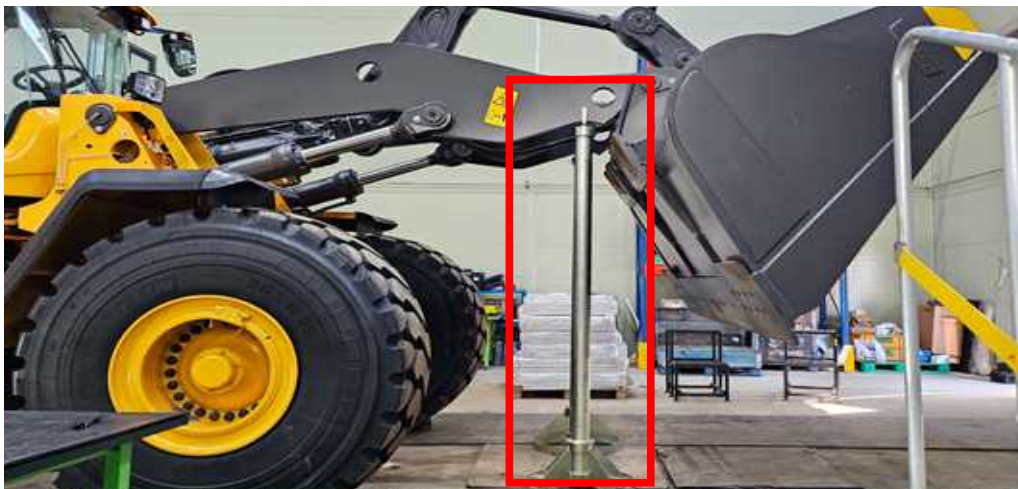
[사진18] 안전 지지대의 예시
