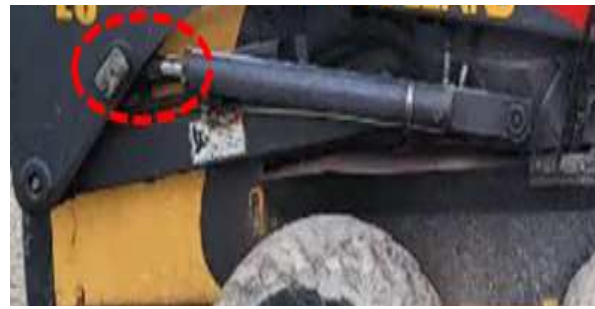
[사진5] (우측) 올바르게 고정된 로더 암 실린더의 예시 (참고용)
